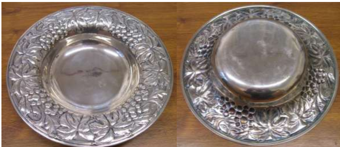
Fotografie 4: mosazná mísa, postříbřená na niklové mezivrstvě, označená falešnou značkou.
